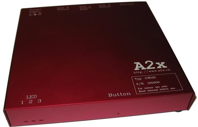
geschaltet. Benutzer, welche sich über das drahtlose Netz mit den anderen Netzen verbinden wollen, müssen sich am Gateway authentifizieren bevor sie das Netz nutzen können. Zusätzlich kann die drahtlose Verbindung zwischen Client und Gateway verschlüsselt werden (VPN Tunnel). Die Benutzer- und die Schlüsselverwaltung ist auf dem Gateway integriert und kann mit jedem Webbrowser erfolgen.
